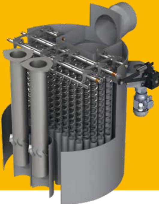
**Intercambiador de calor: siempre limpio automáticamente** Debido a que el intercambiador de calor está dispuesto en vertical en la caldera, el intercambio de calor es óptimo. Además la ceniza puede caer libremente de las superficies del intercambiador de calor. Sólo si el intercambiador de calor se mantiene limpio se puede lograr mantener una alta eficiencia a lo largo de los años. Con un mecanismo de muelle especial la ceniza se suelta de forma eficiente y se hace caer hacia abajo.
